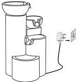
Ligue o cabo de alimentação à tomada. Se instalado corretamente, a água deve fluir da fonte. No primeiro uso, pode haver ar na bomba, por isso pode demorar alguns minutos até que o ar escape.
