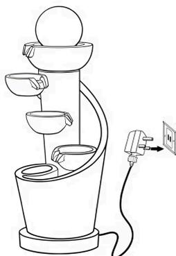
Ligue o cabo de alimentação à tomada. Se instalado corretamente, a água deve fluir da fonte. No primeiro uso, pode haver ar na bomba, por isso pode demorar alguns minutos até que o ar escape.
