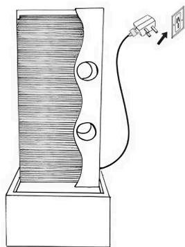
Conecta el cable de alimentación a la toma de corriente. Si se instala correctamente, el agua debería fluir desde la fuente. En el primer uso, es posible que haya aire en la bomba, por lo que puede tardar unos minutos hasta que el aire salga.
