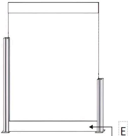
Inserire il **Pezzo Angolare della Recinzione E - Listelli della Recinzione** tra i due **Pezzi Angolari della Recinzione A - Pali in Alluminio con LED**. Assicurarsi che i listelli siano correttamente allineati e si inseriscano saldamente nelle scanalature dei pali.
