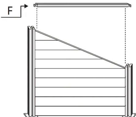
Installa il **Corner Fence Part F - Fence Slat Topper** allineandolo con la parte superiore delle doghe della recinzione installate. Assicurati che si adatti saldamente sulla parte superiore, completando il design a gradini della recinzione.
