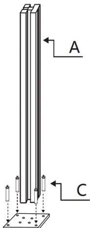
Fissare i **Pali Angolari della Recinzione Parte A - Pali di Recinzione in Alluminio con LED** al suolo inserendo i **Bulloni di Ancoraggio al Suolo Parte C della Recinzione Angolare** attraverso i fori alla base e nel terreno. Assicurarsi che i pali siano stabili e correttamente allineati.
