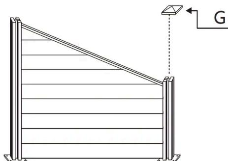
Installa il **Parte Angolare della Recinzione G - Tappo del Palo della Recinzione** allineandolo con la parte superiore del **Parte Angolare della Recinzione A - Pali della Recinzione in Alluminio con LED**. Assicurati che sia posizionato in modo sicuro per completare l'assemblaggio della struttura della recinzione.
