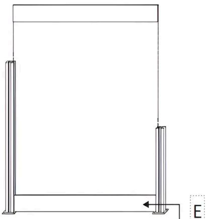
Inserte la **Parte E de la Esquina de la Valla - Lamas de la Valla** entre las dos **Parte A de la Esquina de la Valla - Postes de Aluminio con LED**. Asegúrese de que las lamas estén correctamente alineadas y encajen de manera segura en las ranuras de los postes.
