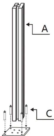
Asegure la **Parte A de la Esquina de la Valla - Postes de Aluminio con LED** al suelo insertando los **Pernos de Anclaje al Suelo de la Parte C de la Esquina de la Valla** a través de los agujeros de la base y en el suelo. Asegúrese de que los postes estén estables y correctamente alineados.
