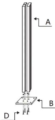
Fije la **Parte A de la Esquina de la Valla - Postes de Valla de Aluminio con LED** a la **Parte B de la Esquina de la Valla - Base del Poste de la Valla** usando los **Tornillos de la Parte D de la Esquina de la Valla - M4x45mm**. Asegúrese de que el poste esté alineado correctamente con la base y apriete bien los tornillos para mantener el poste en su lugar.
