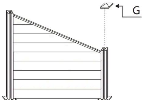
Instale la **Parte G de la Esquina de la Valla - Remate del Poste de la Valla** alineándolo con la parte superior de la **Parte A de la Esquina de la Valla - Postes de Valla de Aluminio con LED**. Asegúrese de que esté colocado de manera segura para completar el ensamblaje de la estructura de la valla.
