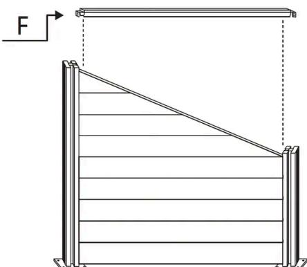
Instale la **Parte F de la Esquina de la Valla - Remate de Lamas de Valla** alineándola con la parte superior de las lamas de la valla ya instaladas. Asegúrese de que encaje de manera segura en la parte superior, completando el diseño escalonado de la valla.
