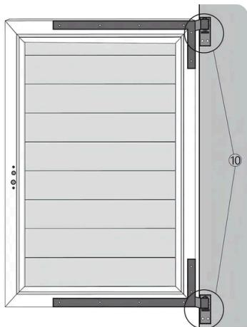
1. Posiziona i **Raccordi di Fissaggio del Cancello** (Parte 10) agli angoli superiori e inferiori del telaio del cancello e fissali ai Pali in Alluminio LED.
