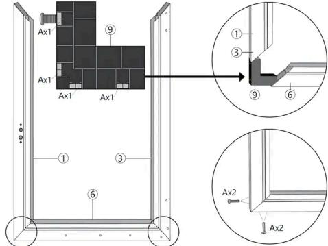
1. Posiziona il **Trave Laterale** (Parte 1) e il **Trave Laterale** (Parte 3) verticalmente.
