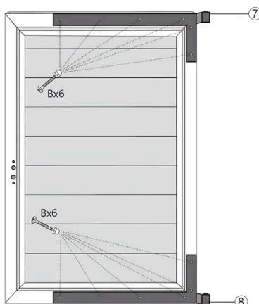
1. Posiziona la **Cerniera Superiore** (Parte 7) all'angolo superiore del telaio del cancello.
