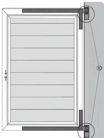
1. Posicione os **Acessórios de Fixação do Portão** (Parte 10) nos cantos superior e inferior da estrutura do portão e fixe-os aos Postes de Alumínio com LED.
