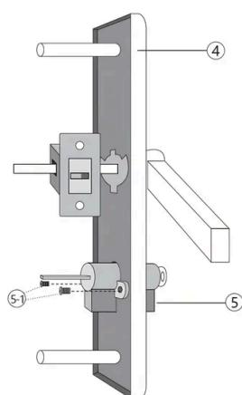
1. Positionnez le **Mécanisme de Clé** (Pièce de Verrouillage 5) dans l'emplacement désigné sur le **Panneau Arrière de la Poignée de Verrouillage** (Pièce de Verrouillage 4).
