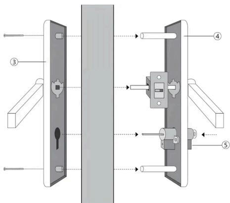
1. Positionnez le **Panneau Avant de la Poignée de Verrouillage** (Pièce de Verrouillage 3) d'un côté du portail, en l'alignant avec les trous désignés.
