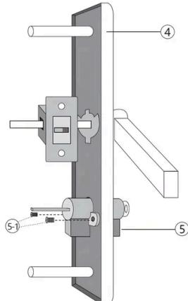
1. Positionieren Sie den **Schlüsselmechanismus** (Schlossteil 5) in den vorgesehenen Schlitz auf der **Rückwand des Schlossgriffs** (Schlossteil 4).
