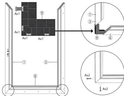
1. Positionieren Sie den **Seitenbalken** (Teil 1) und den **Seitenbalken** (Teil 3) vertikal.
