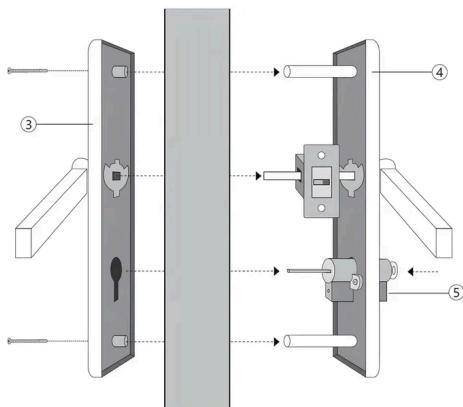
1. Positionieren Sie das **Vorderteil des Schlossgriffs** (Schlossteil 3) auf einer Seite des Tores und richten Sie es an den vorgesehenen Löchern aus.
