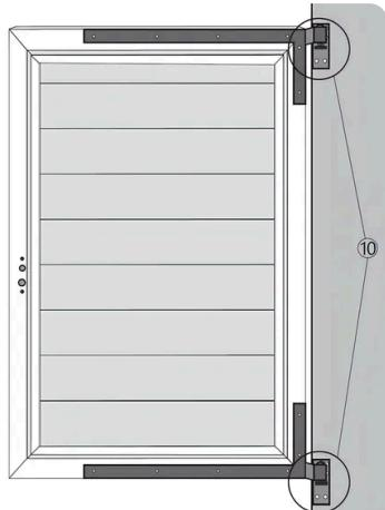
1. Positionieren Sie die **Tor-Befestigungsbeschläge** (Teil 10) an den oberen und unteren Ecken des Torrahmens und befestigen Sie sie an den LED-Aluminium-Pfosten.
