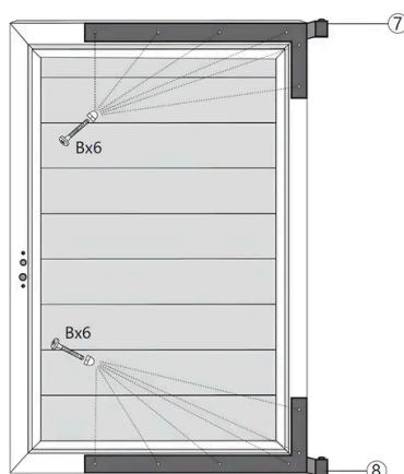
1. Positionieren Sie das **obere Scharnier** (Teil 7) an der oberen Ecke des Torrahmens.
