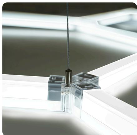
Commencez maintenant à former chaque forme hexagonale en connectant les tubes LED de 440 mm avec des connecteurs en Y à 120° et 360° selon le motif que vous désirez. Assurez-vous qu'un connecteur en Y à 360° soit installé sur le coin d'un hexagone pour permettre la connexion du deuxième câble d'alimentation.
