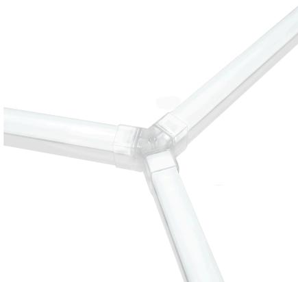
Comece por planejar toda a estrutura de iluminação no chão antes de a montar. Recomendamos que a disponha antes de a ligar. A moldura deve ser construída primeiro, unindo os tubos LED de 565mm utilizando os conectores de duas vias a 180° retos e a 90° de canto. Instale um conector em T no canto da moldura designado para a ligação do cabo de alimentação à fonte de energia. Certifique-se de que os tubos estão totalmente inseridos nos conectores para um ajuste seguro.
