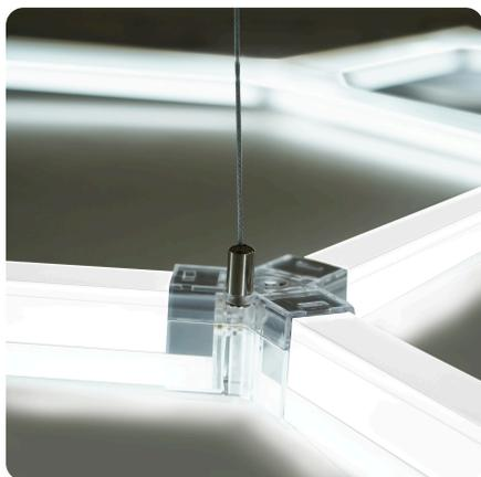
Agora, comece a formar cada forma hexagonal conectando os tubos LED de 440mm com conectores Y de duas vias de 120° e 360° de acordo com o padrão que desejar. Certifique-se de que um conector Y de duas vias de 360° esteja instalado no canto de um hexágono para permitir a conexão do segundo cabo de alimentação.
