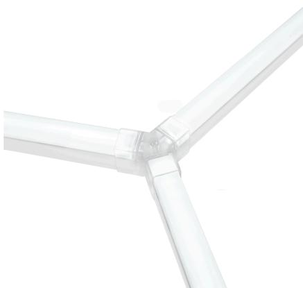
Comience planificando toda la estructura de iluminación en el suelo antes de montarla. Recomendamos disponerla antes de conectarla. El borde debe construirse primero, uniendo los tubos LED de 565 mm utilizando los conectores de dos vías rectos de 180° y de esquina de 90°. Instale un conector en T en la esquina del borde designada para la conexión del cable de alimentación a la fuente de energía. Asegúrese de que los tubos estén completamente insertados en los conectores para un ajuste seguro.
