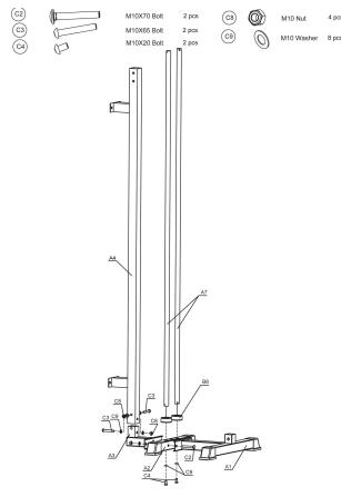
Para montar a base e a estrutura de suporte da Máquina de Polia de Cabo Montada na Parede, siga estes passos:
