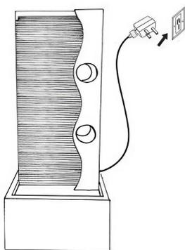
Ligue o cabo de alimentação à tomada. Se instalado corretamente, a água deve fluir da fonte. No primeiro uso, pode haver ar na bomba, por isso pode demorar alguns minutos até que o ar escape.
