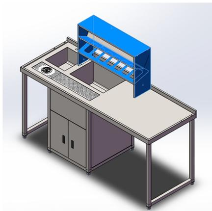
Usando os parafusos Hex fornecidos, encaixe a Prateleira Superior do Meio na Estação de Trabalho de Bubble Tea, certificando-se de apertar bem para fixar adequadamente a prateleira à estação.
