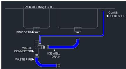
Prenda o refrescador de vidro, o dreno do poço de gelo e o tubo de esgoto ao conector de resíduos. Em seguida, fixe o conector de resíduos ao dreno da pia, apertando firmemente para evitar vazamentos.
